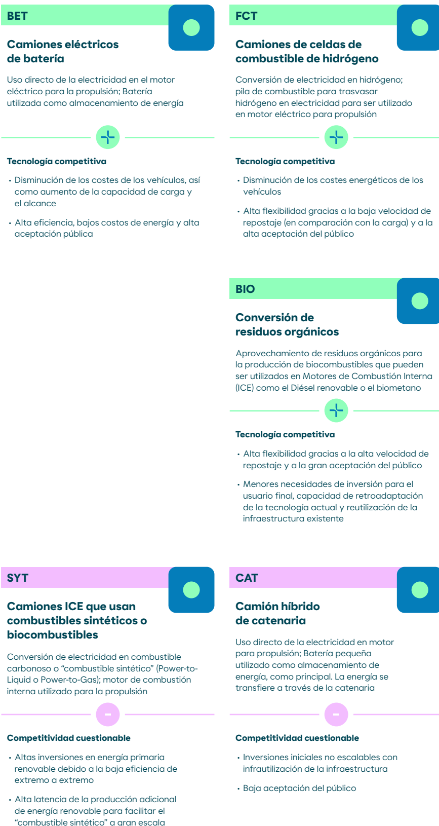
Figura 26 Opciones de tren motriz alternativo para camiones
